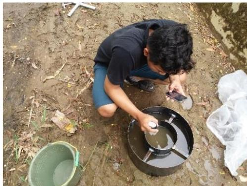
Gambar 10. Pengukuran Infiltrasi dengan Double Ring Infiltrometer
