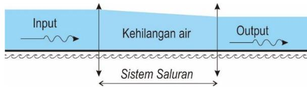
Gambar 3. Prinsip *Input Output* pada Saluran
